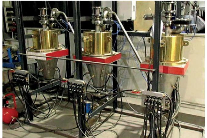
Abb. 4: Im Projekt durch die MMG entwickelte mehrstufige Siebanlage zur Separation von Schleifspänen nach Partikelgröße
