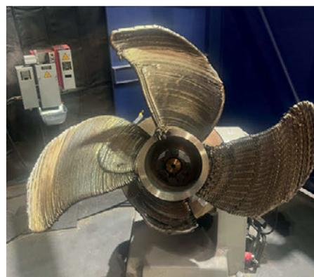
Abb. 3: Erprobung unterschiedlicher Werkzeugbahnen zum Auftragschweißen in der Versuchsanlage bei der MMG
