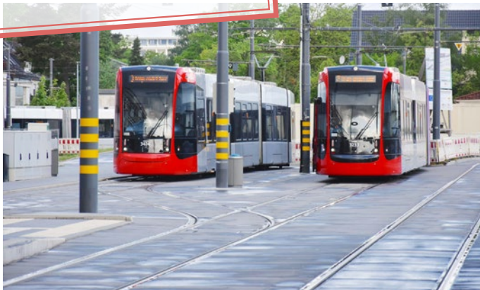
Abb. 18: Zwei Fahrzeuge des Typs GT8N-2 halten an der Warte-position. Davor das Gleiskreuz für eine flexible Ausfahrt. Fotos: F. Muth
