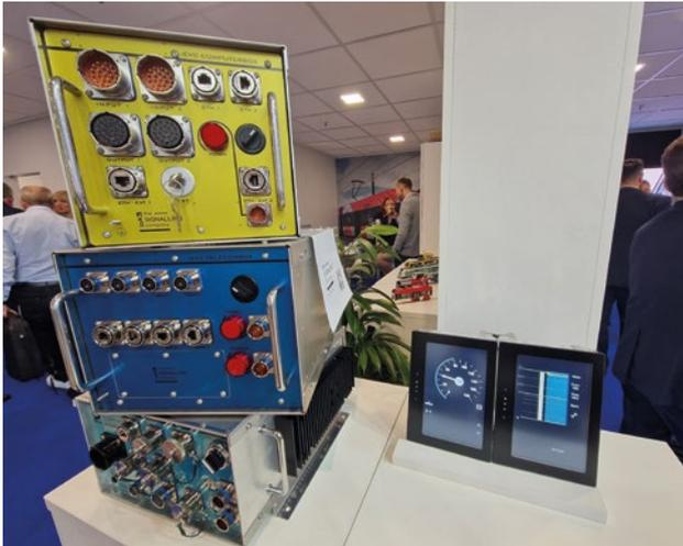
**38:** Das neue kompakte OBU von Skoda Transportation beinhaltet die ETCS-Technik und das Class-B-System
