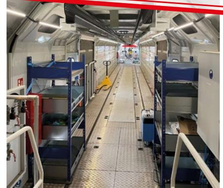
**26:** Die Lagereinheit des FIZ, gut zu erkennen die Kranschiene, die gleichzeitig eine tragende Funktion haben
