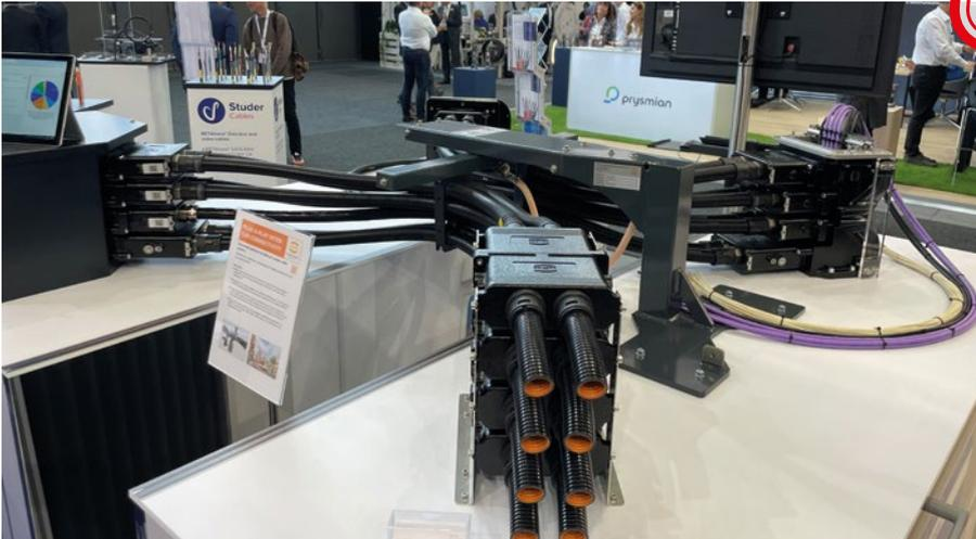
40: Plug & Play-Lösung von Haring und Studer Cables zur Verbindung zweier Wagenkästen
